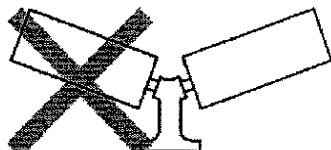
2-х сегментная опора с V-образным желобом
