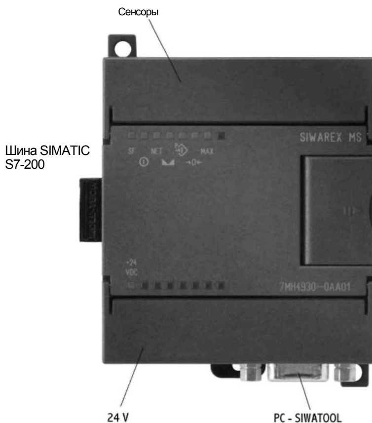
Рисунок 4-1 Области подключения SIWAREX MS
