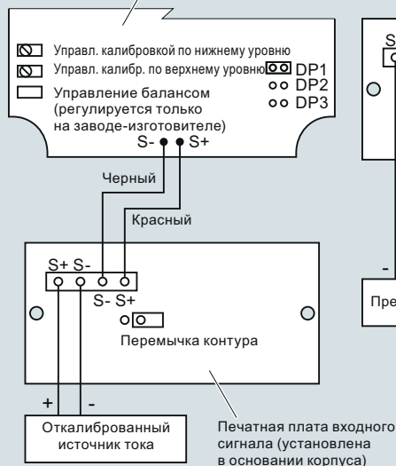
Рис. 1. Калибровочный прибор, подключенный к основной плате без фоновой подсветки
