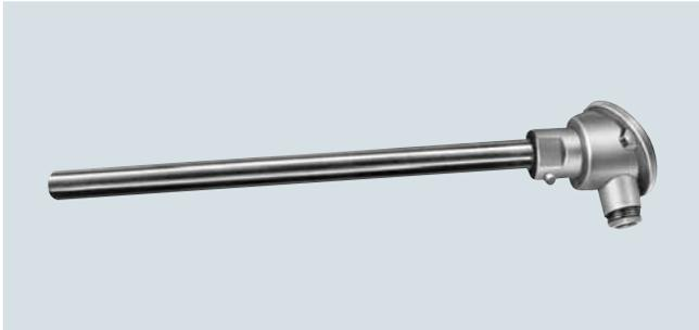
Прямая термопара с металлической защитной трубкой предназначена для измерения температур от 0 до 1250 °C (от 32 до 2282 °F) и может поставляться со встроенным измерительным преобразователем температуры.
