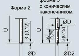
Технологические соединения, размеры в мм (дюймах)
