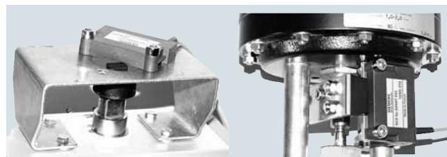
NCS для поворотного привода (6DR4004-N.10), установленный на монтажной консоли (слева), и NCS для поступательного привода ≤ 14 мм (0,55 дюйма) (6DR4004-N.20), установленный на специальном монтажном приспособлении для привода (справа)
