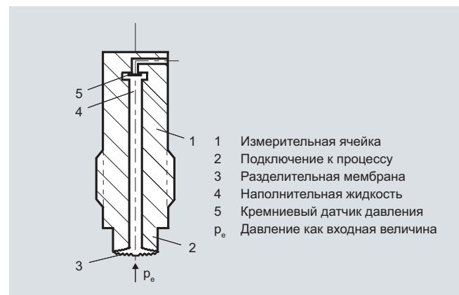
Измерительная ячейка для избыточного давления с плоской мембраной «заподлицо» для бумажной промышленности, функциональная схема
