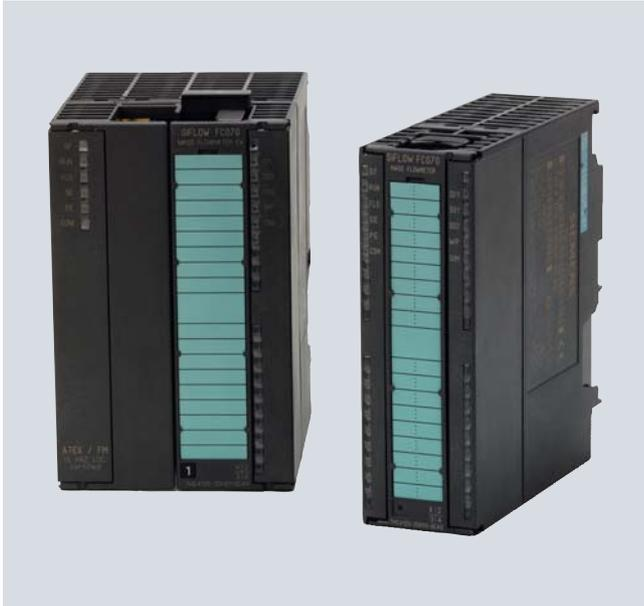
SIFLOW FC070 основан на последних достижениях в области технологии обработки цифрового сигнала — спроектированный для высокой производительности, быстрого отклика на изменения потока, быстрых режимов дозирования, высокой устойчивости к шумам процесса, легкой установки, ввода в эксплуатацию и поддержки.
