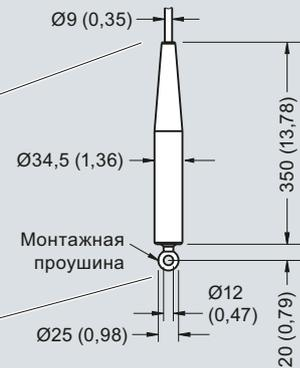
Удлиненная кабельная версия с антенным датчиком, приварной фланец (7ML5523)
