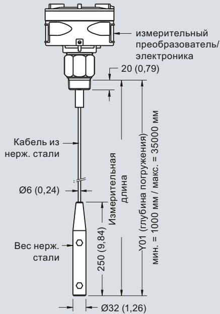
Кабельная версия (изолированная)<sup>2)</sup>, приварной фланец (7ML5513)
