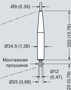
SITRANS LC300 — резьбовые подключения к процессу, габариты в мм (дюйм)
