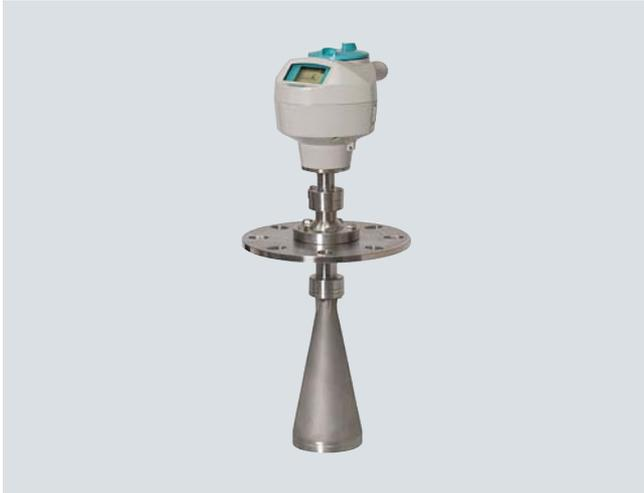
SITRANS LR260 — 2-проводной работающий на частоте 25 ГГц импульсный радар для непрерывного контроля уровня сухих веществ в резервуарах для хранения, приборы могут эксплуатироваться в условиях высокой запыленности и высоких температур, диапазон измерения: 0–30 м.
