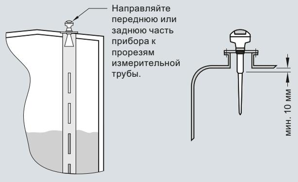
Монтаж SITRANS LR200, габариты в мм
