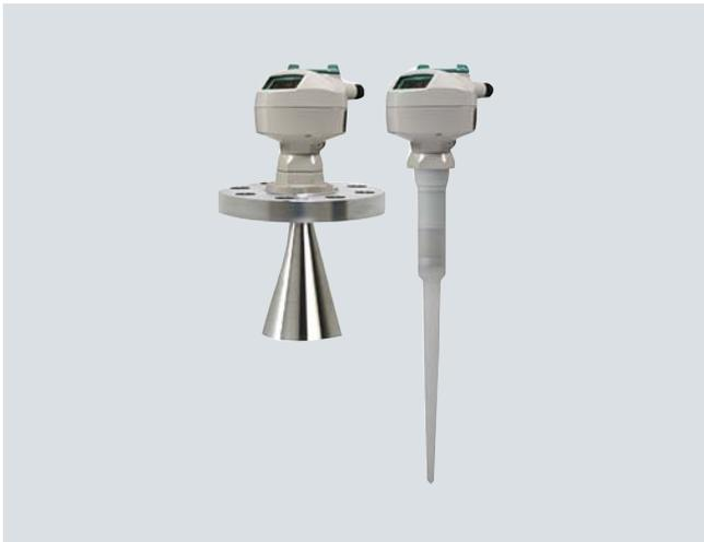
SITRANS LR200 — 2-проводной работающий на частоте 6 ГГц импульсный радар для непрерывного контроля уровня жидкостей и взвесей в резервуарах для хранения и технологических резервуарах в условиях высокого давления и температуры, диапазон измерения: 0–20 м.
