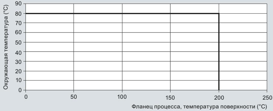
Кривые снижения рабочих параметров SITRANS LR260 при изменении температуры окружающей среды или температуры поверхности фланцевого подключения к процессу.
