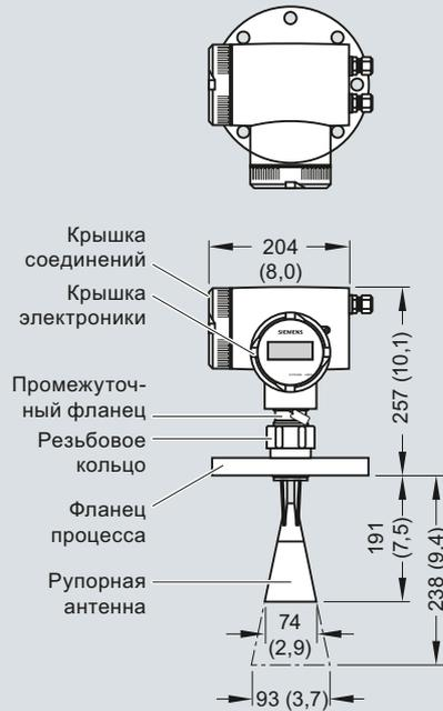
SITRANS LR400 (с термоизоляционным удлинением)
