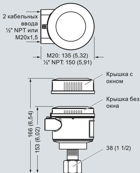
7ML1301-1 (7xA-x) Зонд, Резьбовое и Фланцевое подключение
