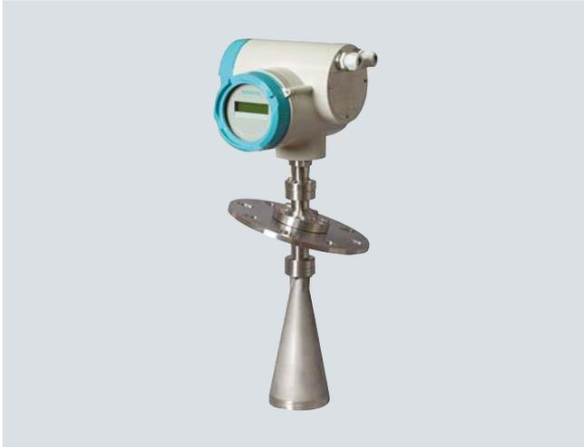
SITRANS LR460 — 4-проводной работающий на частоте 24 ГГц радар для непрерывного контроля уровня сухих веществ, чрезвычайно высокое отношение сигнал/шум, передовая технология обработки сигналов, диапазон измерения: 0–100 м. Идеально подходит для работы в условиях высокой запыленности.
