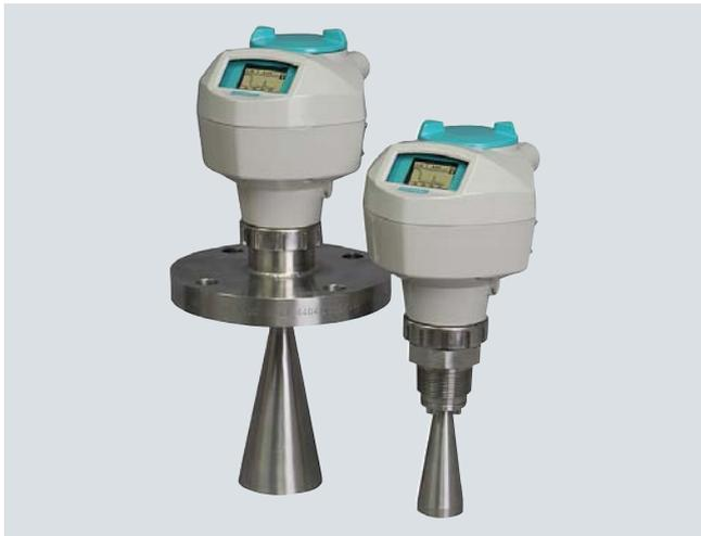
SITRANS LR250 — 2-проводной работающий на частоте 25 ГГц импульсный радар для непрерывного контроля уровня жидкостей и взвесей в резервуарах для хранения и технологических резервуарах в условиях высокого давления и температуры, диапазон измерения: 0–20 м.
