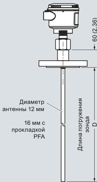
7ML1304-2 (7x2-x) гибкий зонд для крупных твердых частиц, резьбовое или фланцевое соединение
