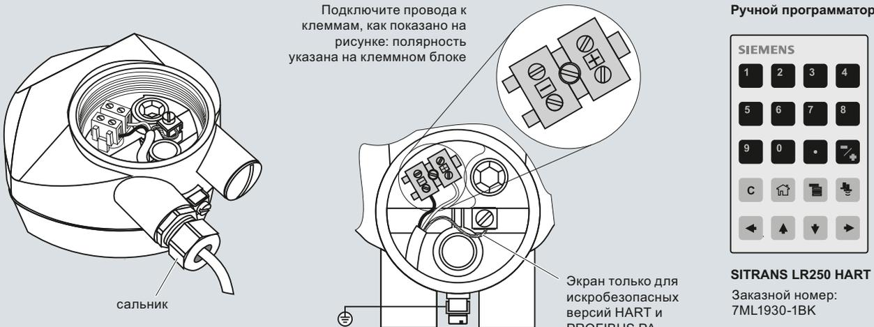
Подключите провода к клеммам, как показано на рисунке: полярность указана на клеммном блоке
