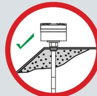
Накопление материала или конденсата в области Active Shield не влияет на работу прибора
