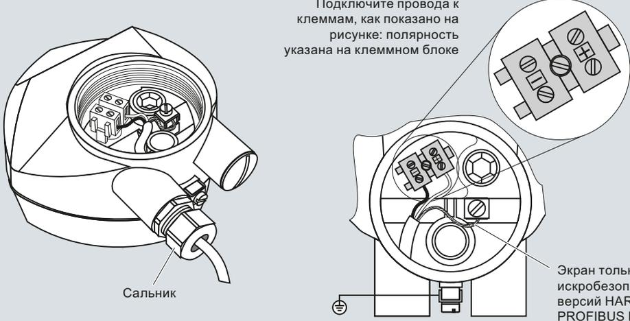
Подключите провода к клеммам, как показано на рисунке: полярность указана на клеммном блоке
