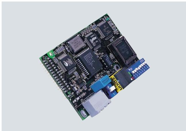
Модули SmartLinx® обеспечивают прямое цифровое подключение к популярным промышленным каналам связи, полная совместимость с продуктами производства Siemens, никакое дополнительное оборудование не требуется.
