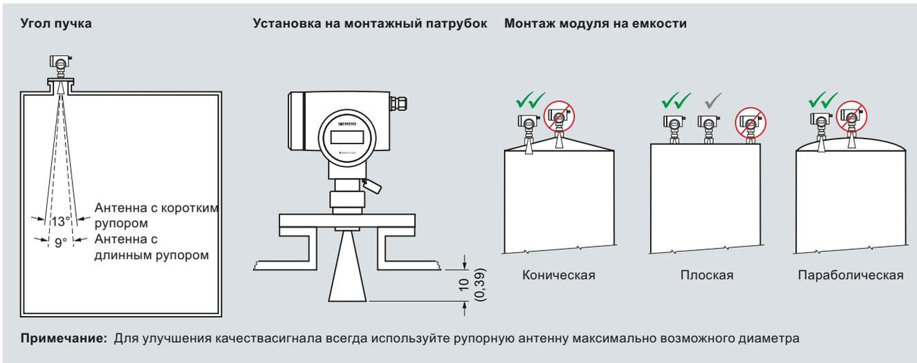
Монтаж SITRANS LR400, габариты в мм (дюйм)
