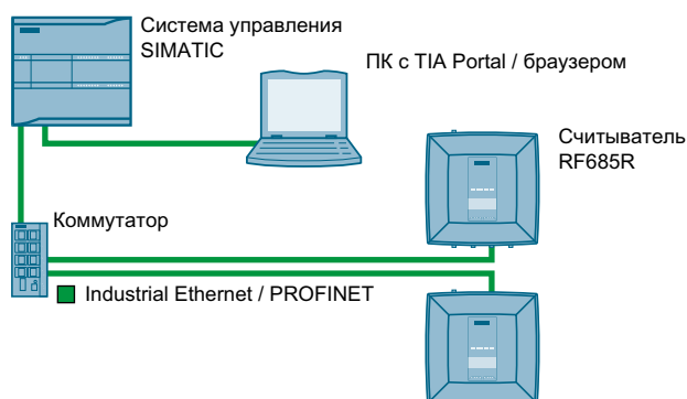
Рисунок 4-1 Пример конфигурации топологии «звезда»
