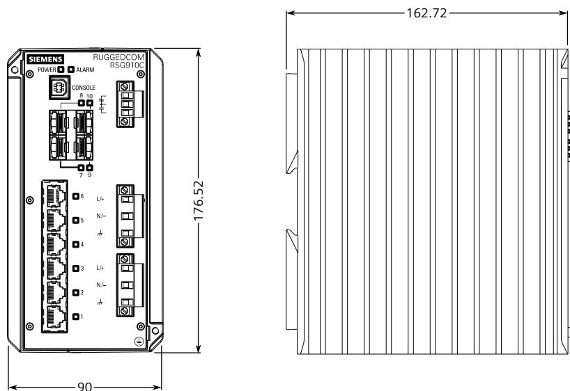
Рисунок 5.1 Габаритные размеры
