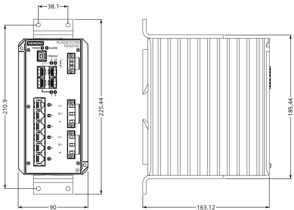
Рисунок 5.2 Размеры при монтаже на панель
