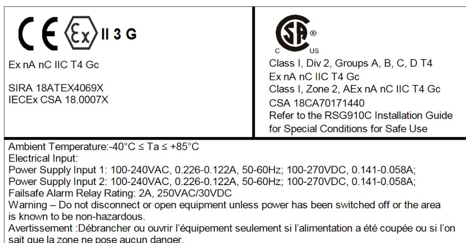
Рисунок 2.1 Табличка соответствия (пример)
