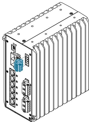
Рисунок 2.6 Сборка клеммной колодки реле аварийной сигнализации
