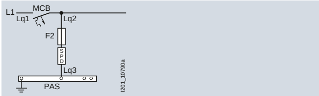
а) Защита ограничителей перенапряжений с использованием модульных автоматических выключателей.
