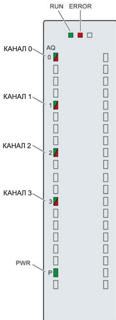
Рис 5-1 Светодиоды индикации модуля AQ 4xU/I ST
