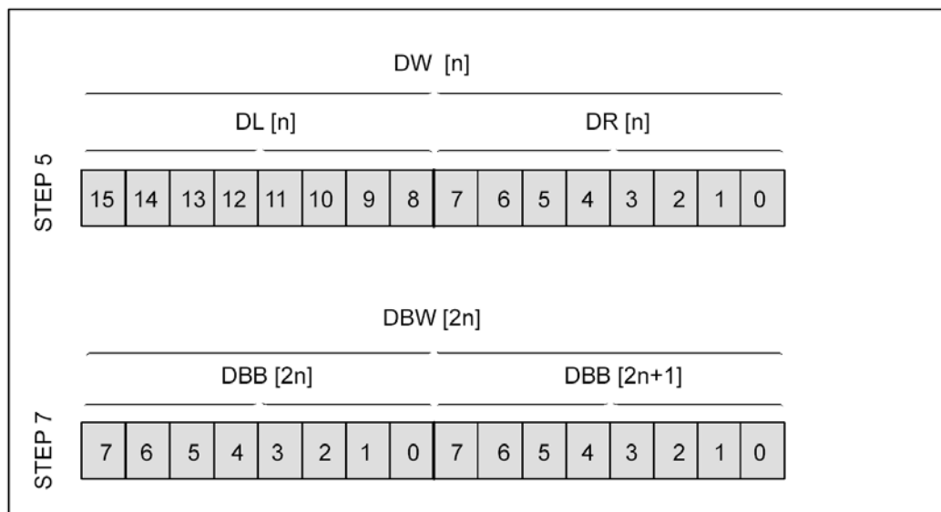
Рис. 6-7 Сравнение систем адресации в STEP 5 и STEP 7
