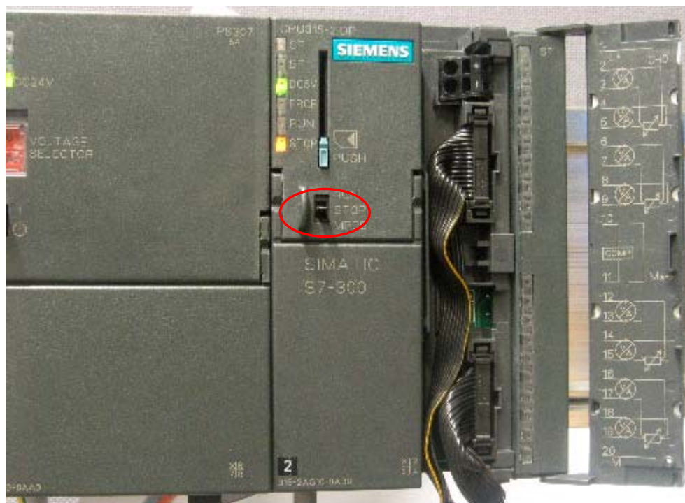
Рис. 5-1 Правильно выполненный монтаж: CPU в режиме STOP При загорании красного светодиода проверьте правильность монтажа.
