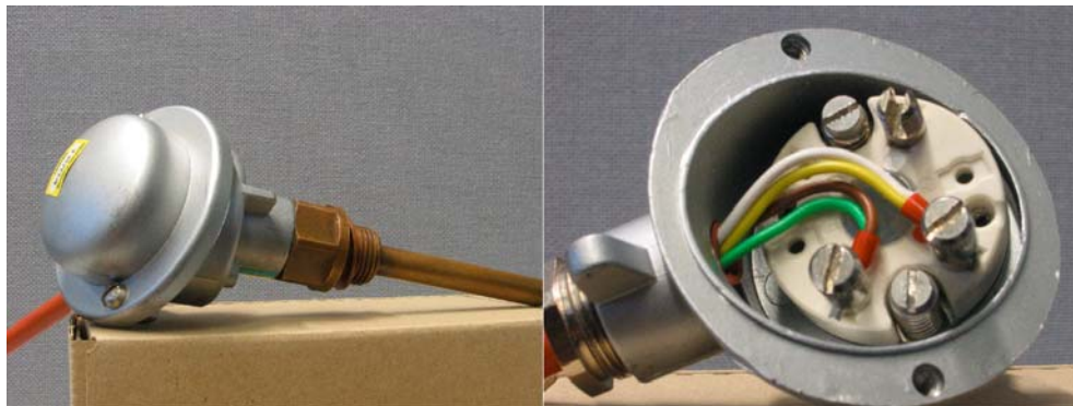
Рис. 5-1 Монтаж PT100 с помощью 4-проводного соединителя
