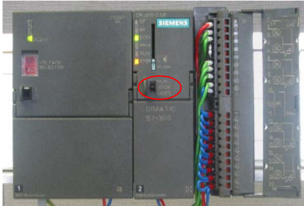
Рисунок 5-1 Проверка монтажа, CPU в режиме STOP
