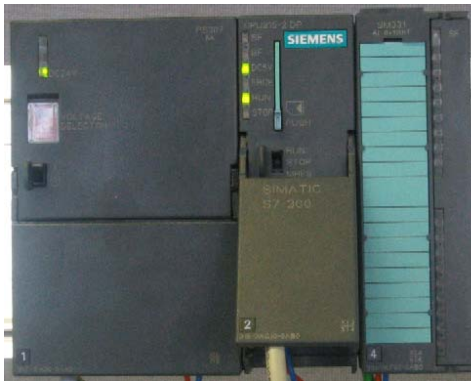
Рисунок 6-3 CPU в нормальном режиме работы (без ошибок)
