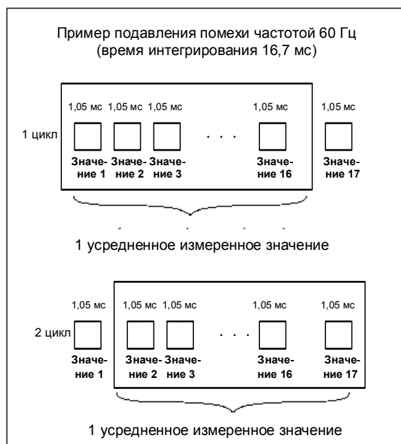
Рис. 7-12. Подавление помехи частотой 60 Гц
