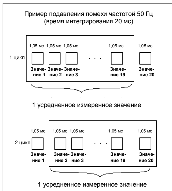
Рис. 7-11. Подавление помехи частотой 50 Гц
