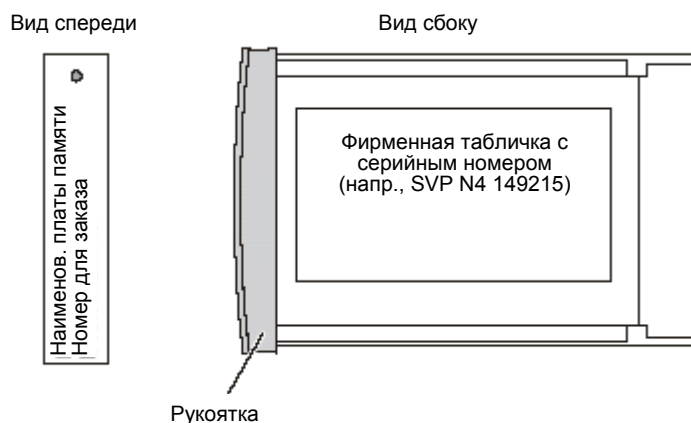
Рис. 2-8. Устройство платы памяти
