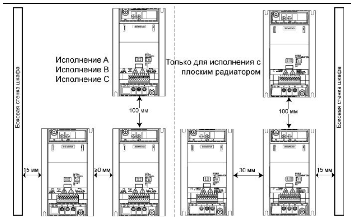
Рис. 2-4 Монтажные зазоры для установки нескольких преобразователей SINAMICS G110.
