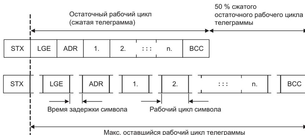
Изображены Рабочий цикл телеграммы как сумма остаточного рабочего цикла и времен задержки
