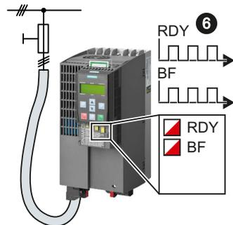
**Примечание****Повреждение FW при нарушении электропитания в процессе передачи**
