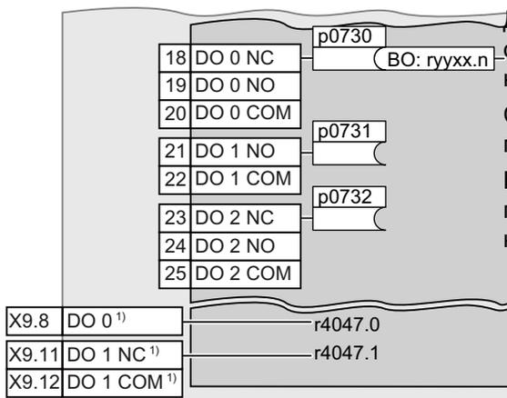
Для изменения функции цифрового выхода, соедините цифровой выход с выходным бинектором на свой выбор.
