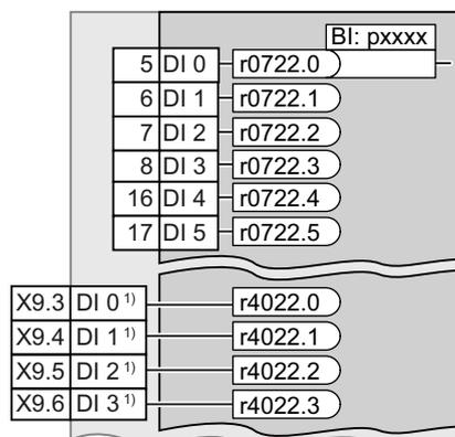
Для изменения функции цифрового входа, соедините параметр состояния цифрового входа с входным бинектором на свой выбор.
