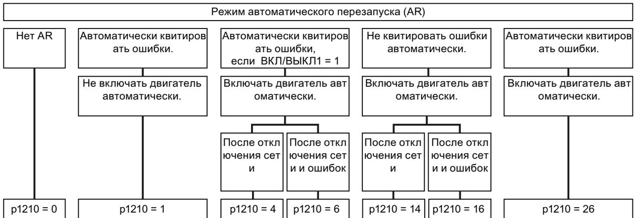
Рис. 8-25 Режимы автоматики повторного включения
