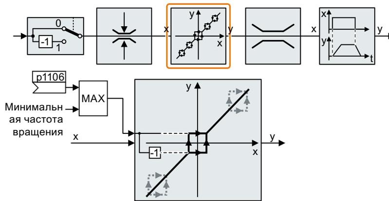
Значения частоты вращения, меньше мин. частоты вращения по величине, допускаются при работе двигателя только при разгоне или торможении.
