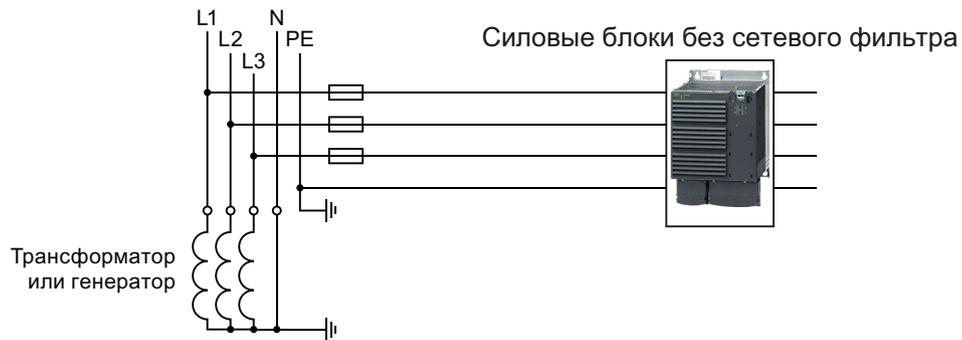
Рис. 4-3 Сеть ТТ с передачей нейтрального провода N
