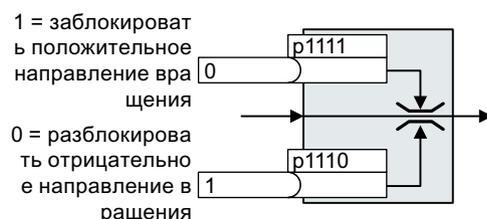
Для беспрерывного разрешения отрицательных направлений вращения установите параметр p1110 на значение = 0.
