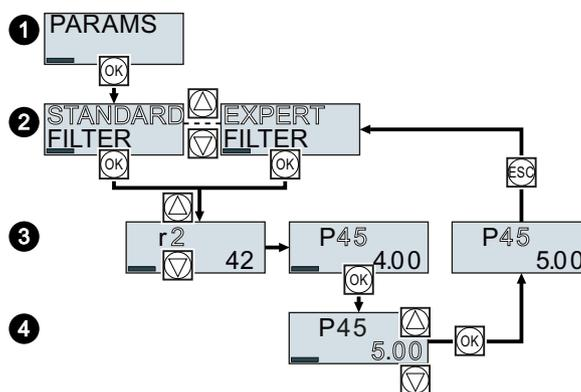
3. Выберите с помощью кнопок-стрелок требуемый номер параметра для записи. Нажмите кнопку ОК.
