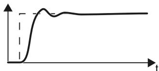
**Оптимальная регулировочная характеристика для быстрого отклика и быстрой компенсации составляющих возмущения.**
