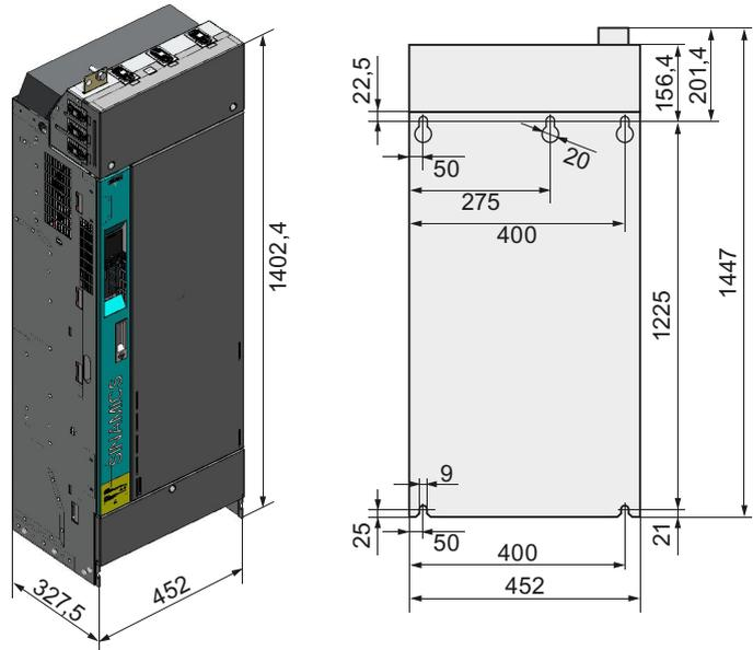
**Размеры и схемы сверления для силовых модулей с внешней вентиляцией**
