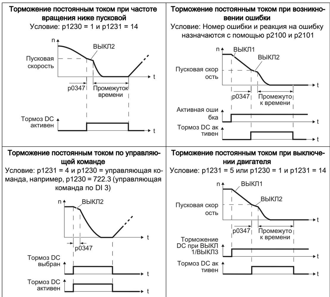
**Торможение постоянным током при частоте вращения ниже пусковой**
