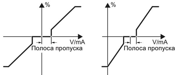
Мешающие воздействия на кабеле могут нарушать слабые сигналы в несколько милливольт. Для точной установки заданного значения в 0 В через аналоговый вход необходимо определить полосу пропускa.
