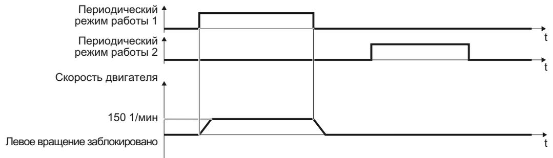
Рис. 5-2 Периодический режим двигателя в заводской настройке
