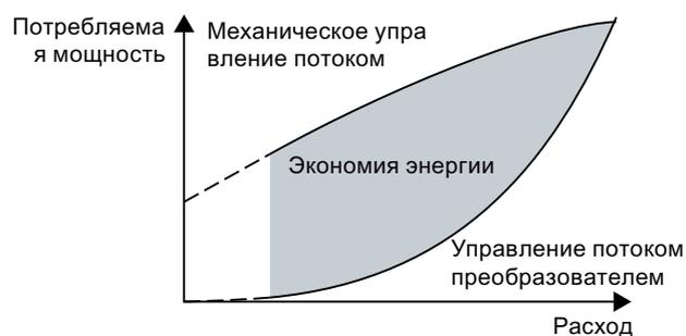
Преобразователь рассчитывает сэкономленную энергию управления потоком с преобразователем относительно механического управления потоком на основании сохраненной характеристики потока. Расчет подходит для гидравлических машин, например, центробежных насосов, вентиляторов, центробежных или осевых компрессоров.
