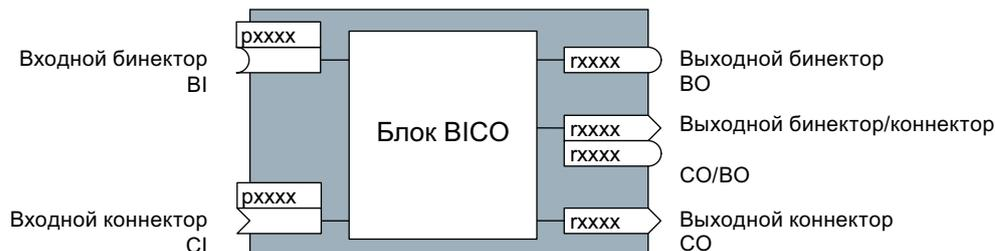
Рис. А-7 Символы для входных и выходных бинекторов и коннекторов
