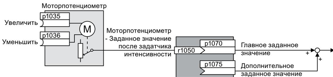
Рис. 8-14 Потенциометр двигателя как источник заданного значения
