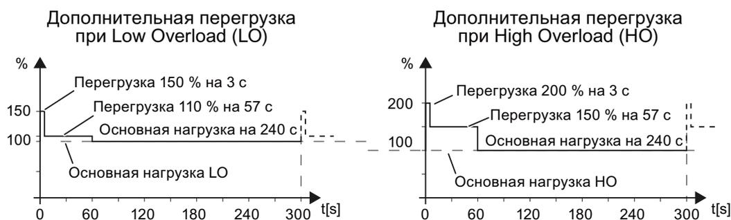
Рис. 12-3 Нагрузочные циклы, «Low Overload» и «High Overload»
