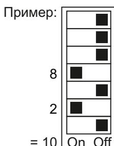
Адрес PROFIBUS преобразователя настраивается при помощи переключателей адресов на управляющем модуле, через параметр p0918 или в STARTER. Через параметр p0918 (заводская настройка: 126) или через STARTER адрес можно установить только тогда, когда все переключатели адреса стоят на «OFF» (0) или «ON» (1). Если действительный адрес задается через переключатели адресов, то всегда действует этот адрес и параметр p0918 не может быть изменен.
