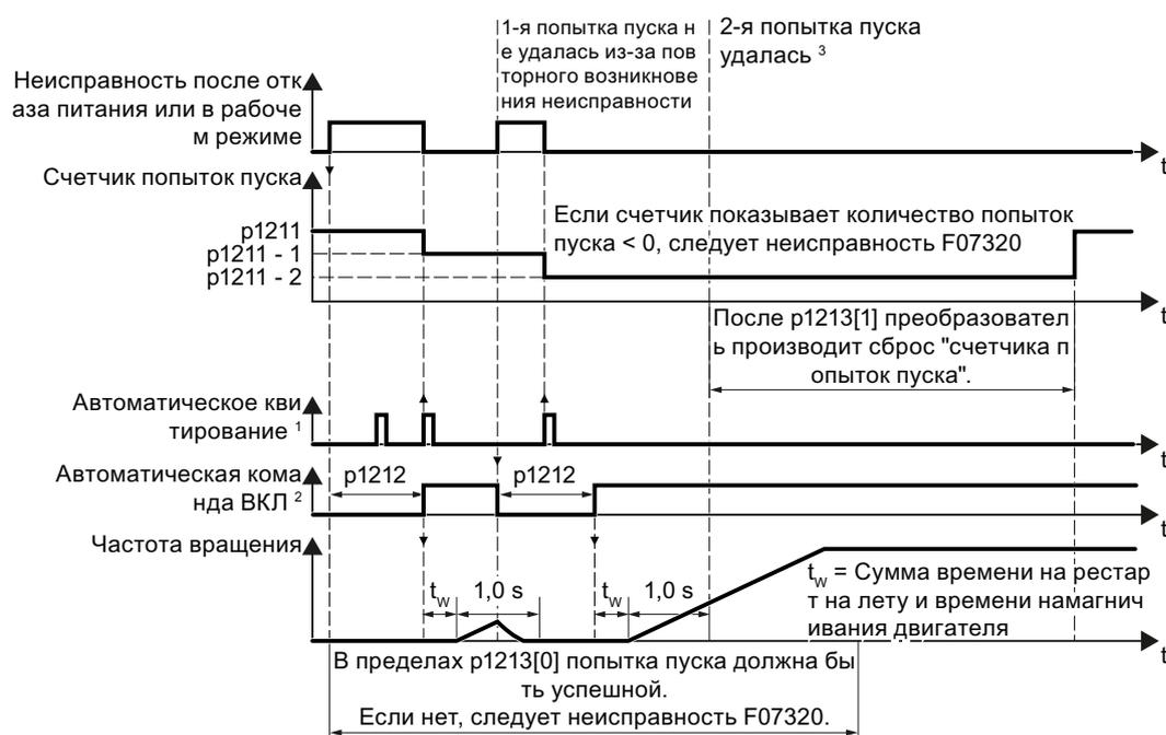
1) Преобразователь при следующих условиях квитирует неисправности автоматически:
