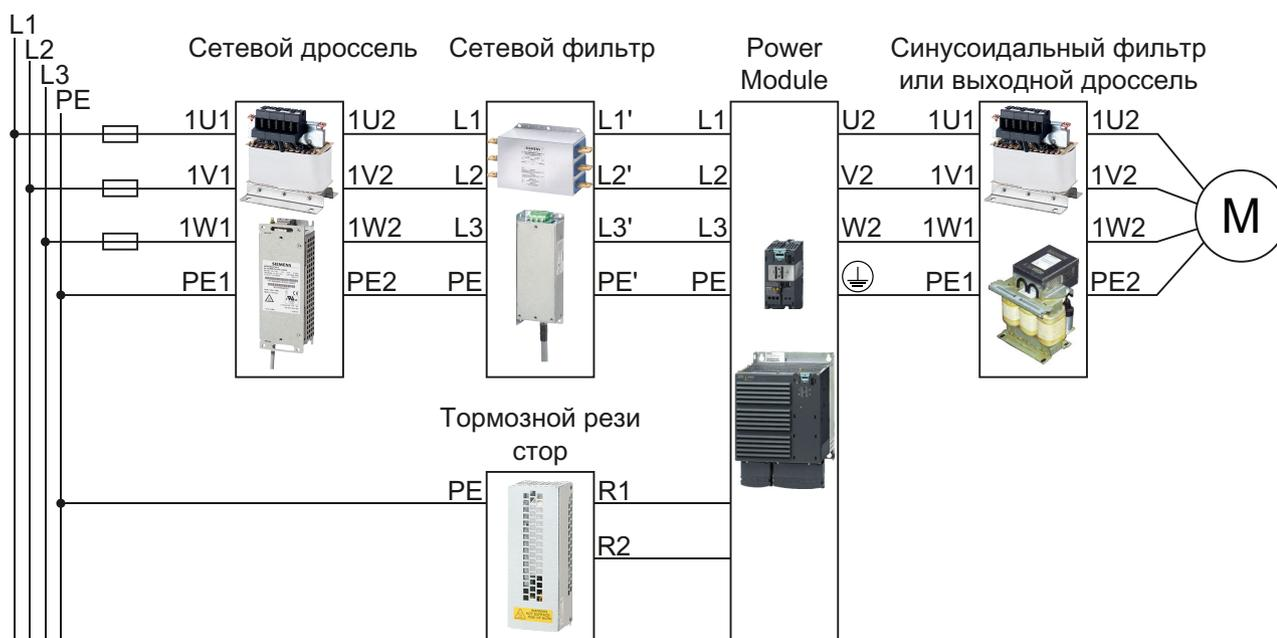
Рис. 4-7 Подключение силовых модулей PM240, PM240-2 IP20 и с внешней вентиляцией
