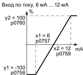
Для настройки аналогового входа в качестве контролируемого токового входа установите следующие параметры:
