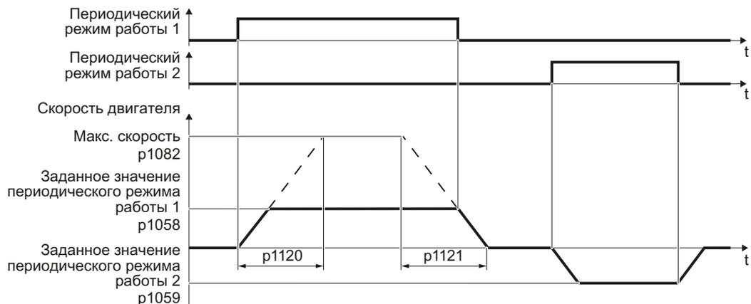
Рис. 8-8 Поведение двигателя в "Толчковом режиме работы"
