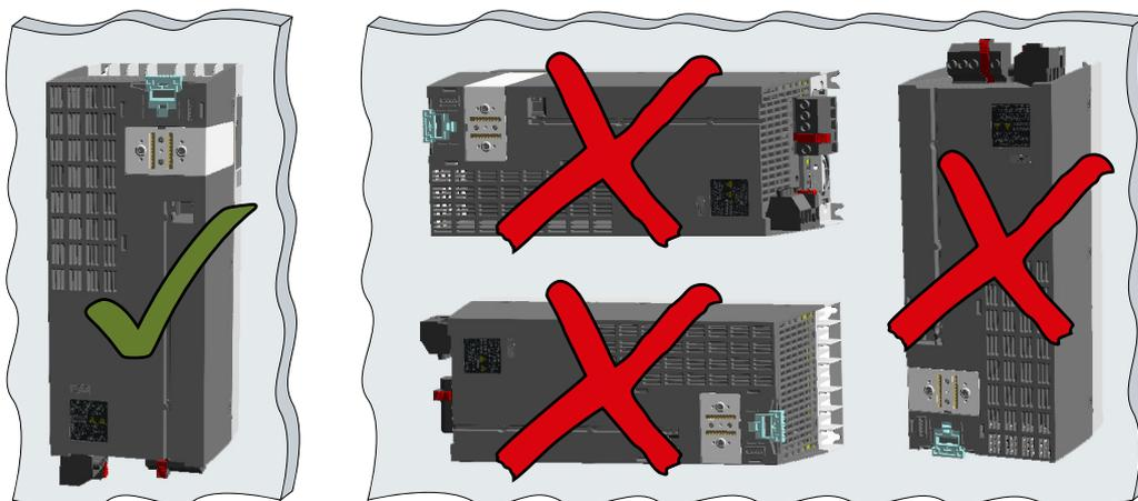
4. Разместите силовой модуль в электрошкафу таким образом, чтобы оставить свободное место для подключения кабелей двигателя и питания согласно расположению клемм.
