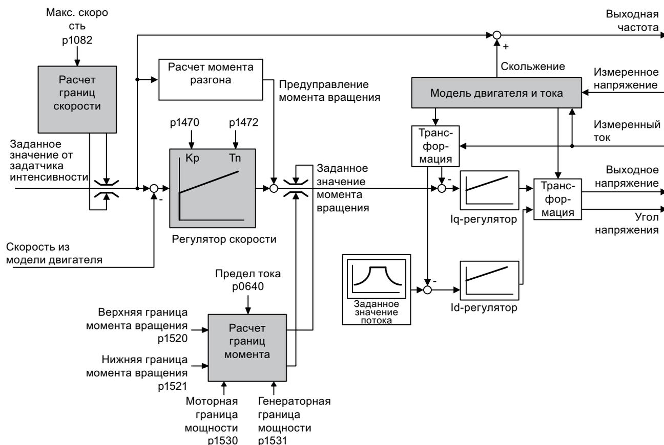
Рис. 8-20 Упрощенная функциональная схема векторного управления без датчика
