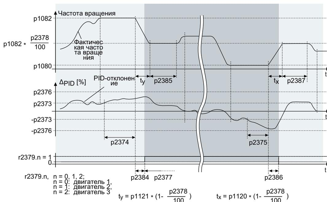
Рис. 8-36 Условие для подключения или отключения нерегулируемого двигателя
