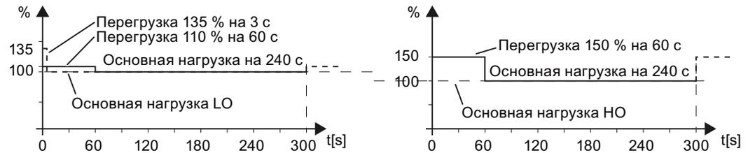
Рис. 12-6 Нагрузочные циклы, «Low Overload» и «High Overload»
