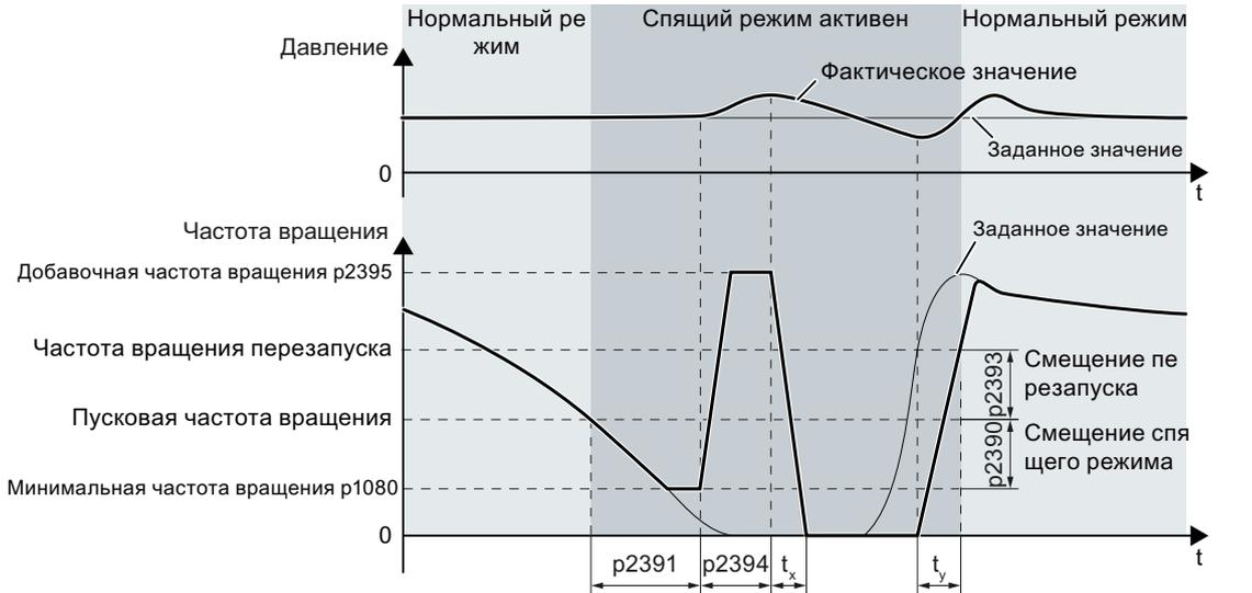
$$\begin{aligned} \text{Частота вращения перезапуска} &= p1080 + p2390 + p2393 & t_x &= p2395 / p1082 * p1121 \\ \text{Пусковая частота вращения} &= p1080 + p2390 & t_y &= \text{частота вращения перезапуска} / p1082 * p1120 \end{aligned}$$
