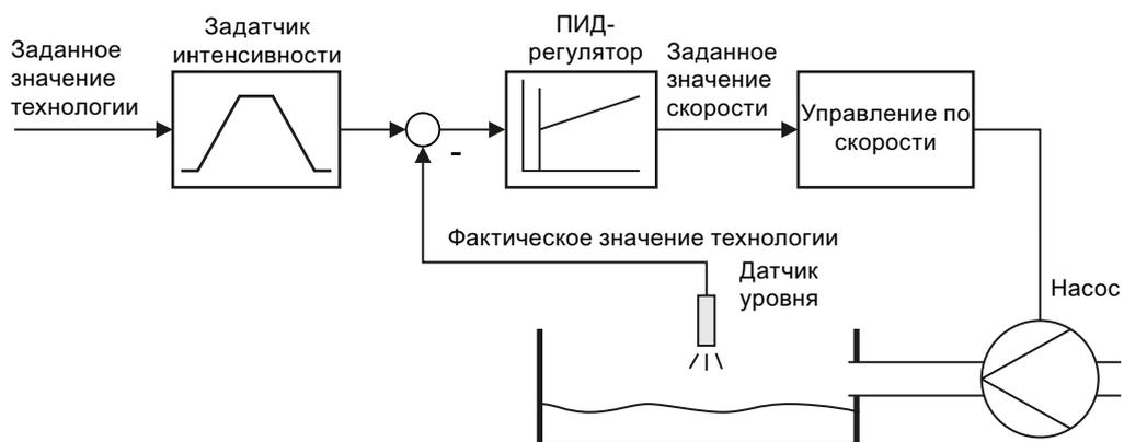
Рис. 8-28 Пример использования технологического регулятора как регулятора уровня
