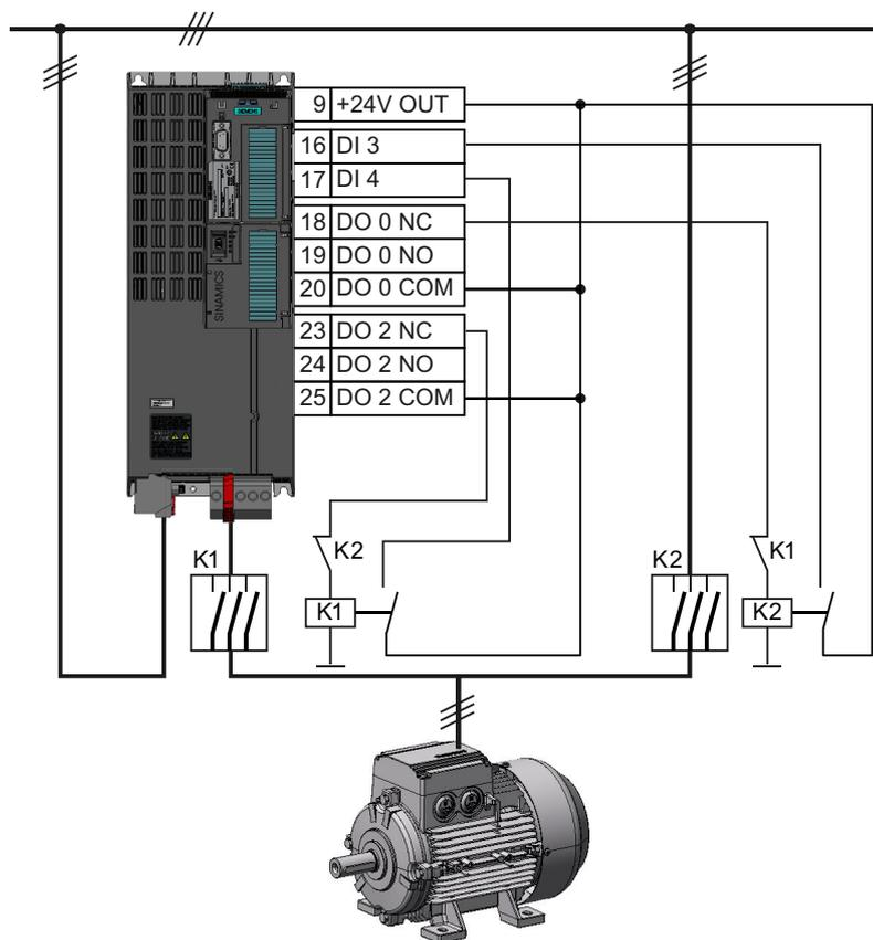
Рис. 8-33 Байпасное включение для управления через преобразователь
