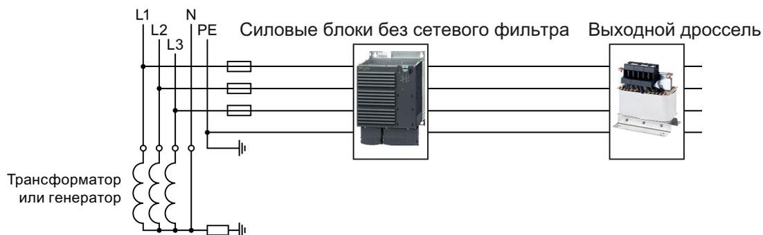
Рис. 4-4 Сеть IT с передачей нейтрального провода N и сопротивление относительно защитного провода PE
