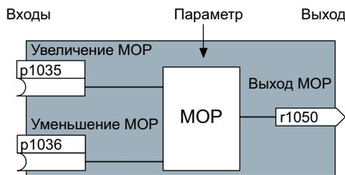
Рис. А-5 Пример блока: Моторпотенциометр (МОП)
