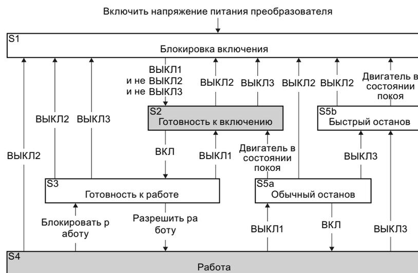
Рис. 8-2 Внутреннее ЦПУ преобразователя при включении и выключении двигателя
