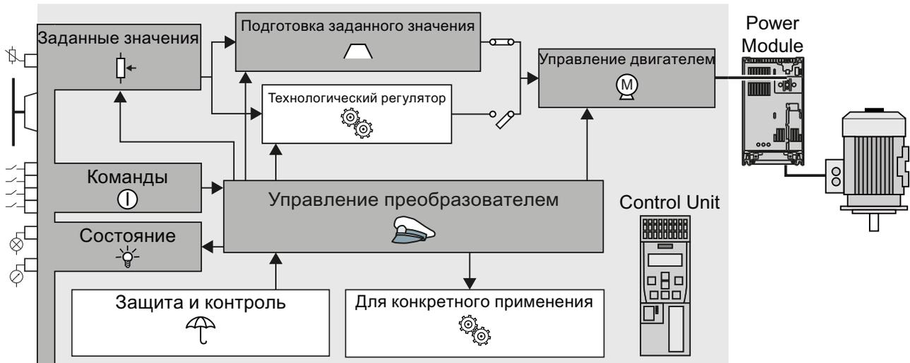
Рис. 8-1 Обзор функций в преобразователе
