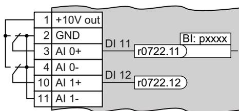
Для использования аналогового входа в качестве дополнительного цифрового входа следует соединить аналоговый вход, как показано на рисунке, и подключить один из параметров состояния r0722.11 или r0722.12 к любому входу бинектора.
