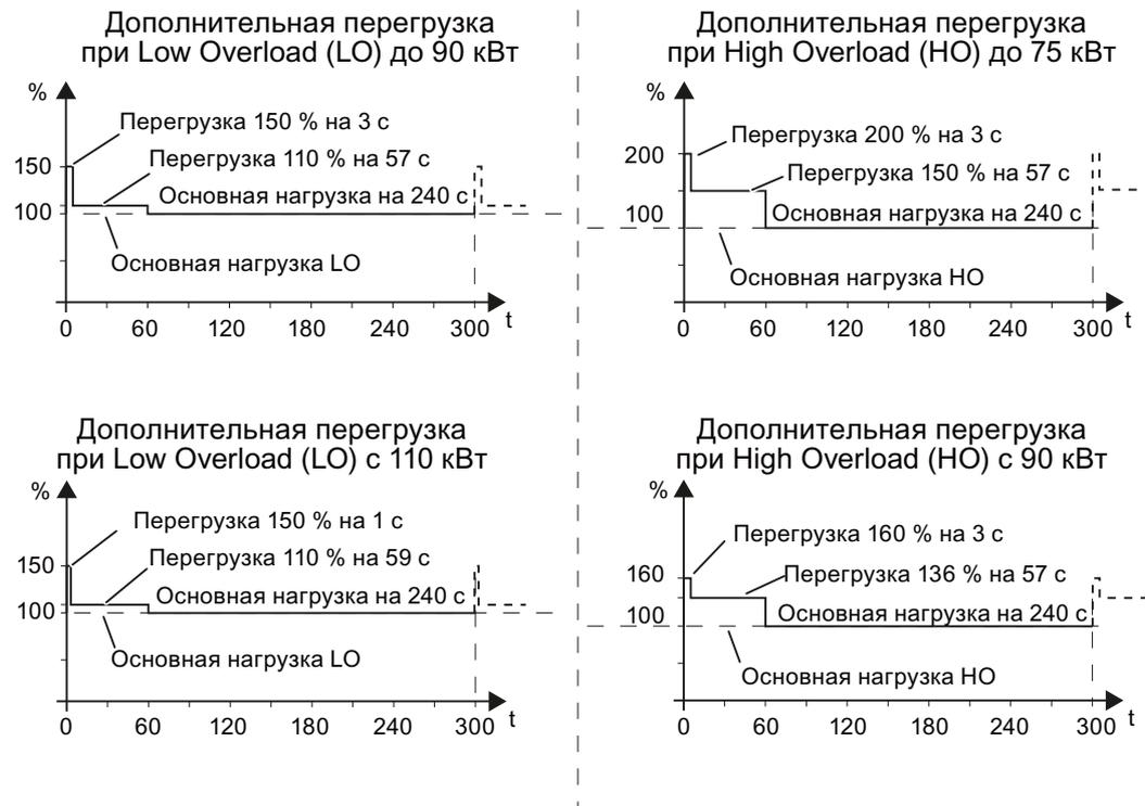
Рис. 12-2 Нагрузочные циклы, «Low Overload» и «High Overload»
