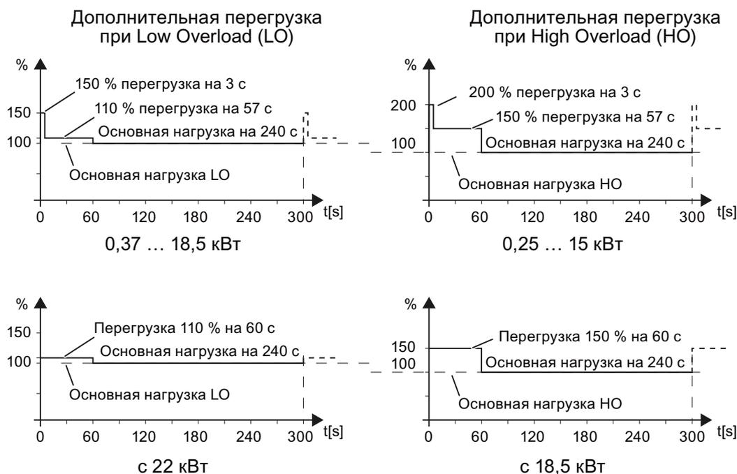
Рис. 12-1 Нагрузочные циклы, "High Overload" и "Low Overload"
