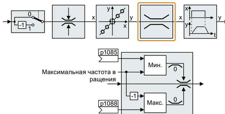
При превышении макс. частоты вращения преобразователь создает сообщение (ошибку или предупреждение).
