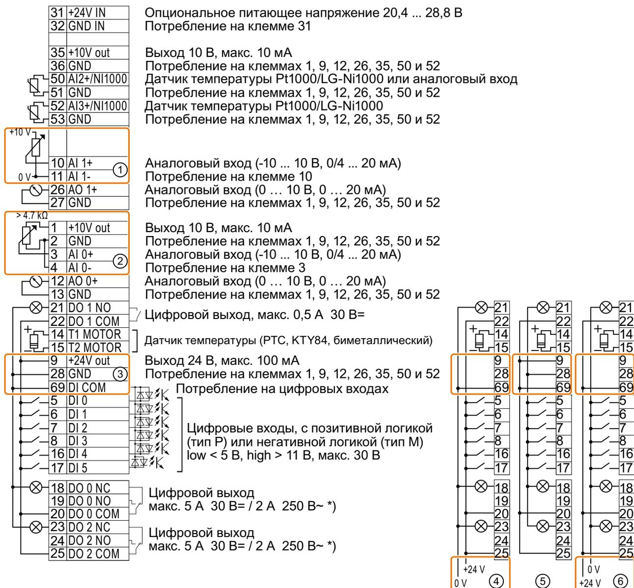
\*) В соответствии с UL, для установок действует: С помощью клемм 18 / 20 (DO 0 NC) и 23 / 25 (DO 2 NC) разрешается подключать макс. 3 А 30 В= или 2 А 250 В~.
