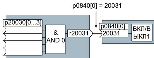
Рис. А-9 Соединение блоков через установку r0840[0] = 20031
