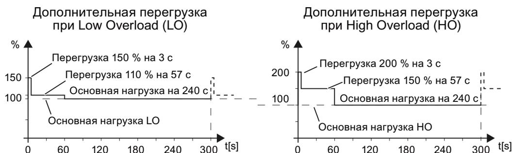
Рис. 12-5 Нагрузочные циклы, «Low Overload» и «High Overload»
