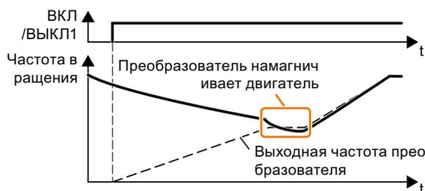
Рис. 8-24 Принцип действия функции «Рестарт на лету»
