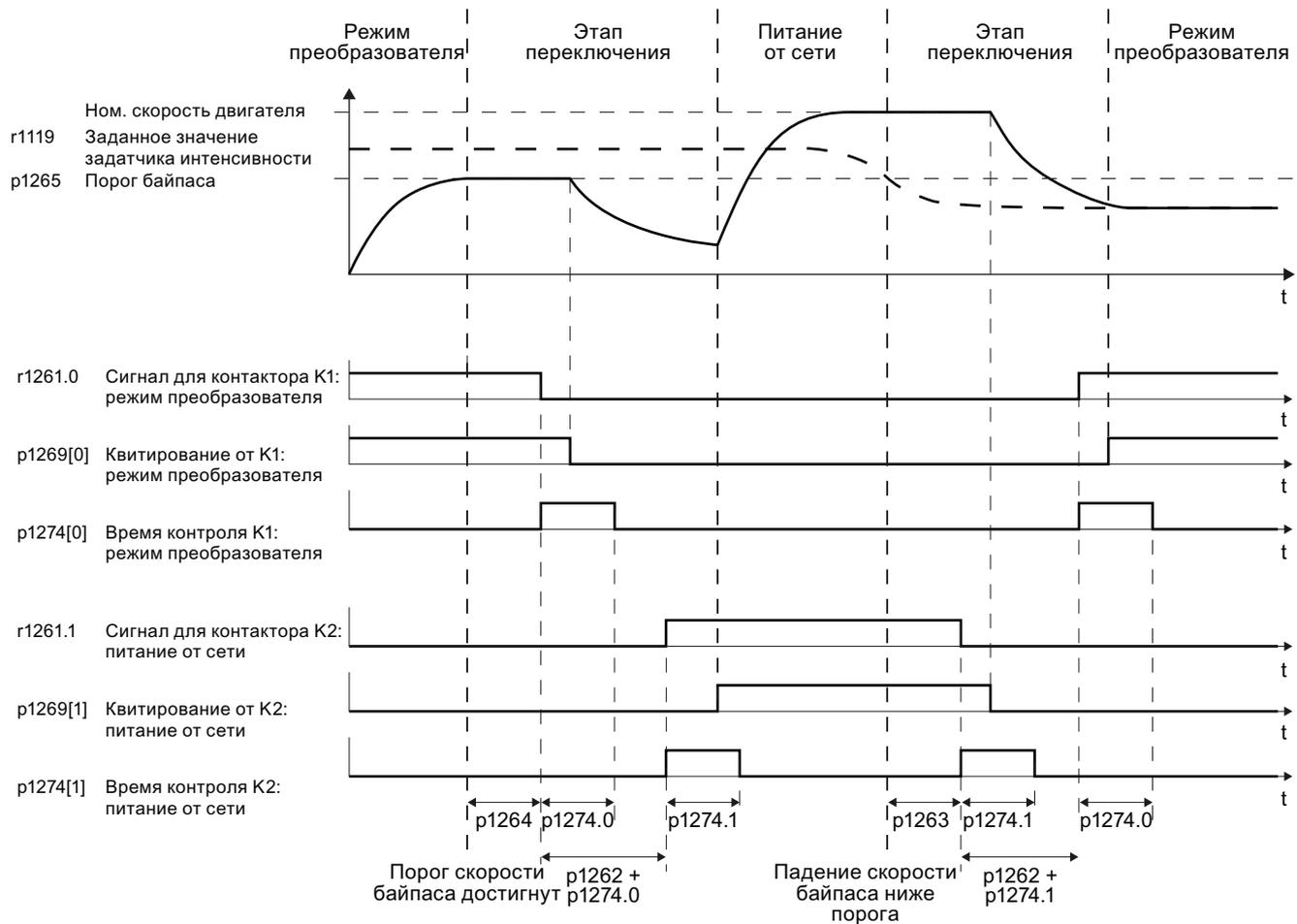
Рис. 8-35 Зависящая от частоты вращения характеристика переключения из режима преобразователя на питание от сети
