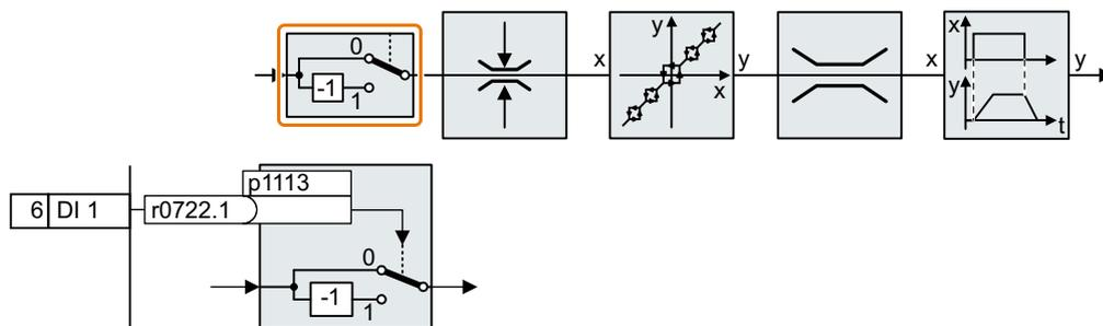
Для инверсии заданного значения через цифровой вход DI 1 соедините параметр p1113 с двоичным сигналом, например, с цифровым входом 1.
