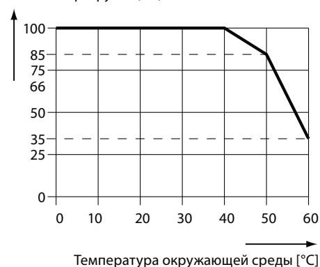
Изображение 6-2 Снижение номинальных значений параметров тока согласно Температура, PM230 FSA ... FSF
