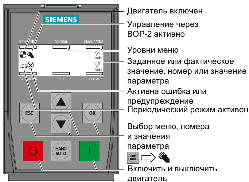
Изображение 4-1 Элементы управления и индикации BOP-2
