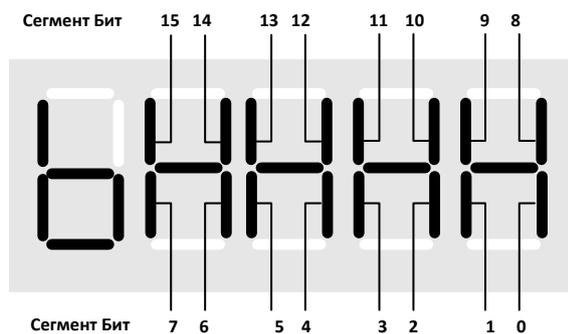
Значение релевантных битов на индикации описывается в параметрах слова состояния и управляющего слова.
