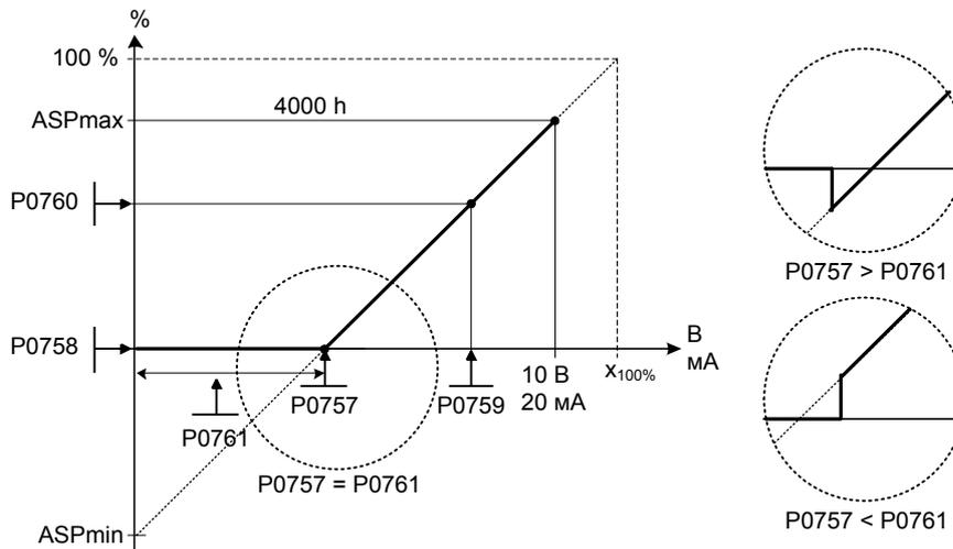
Пример ниже дает аналоговый вход 0 до 10 В (-50 - +50 Гц) с нулевой точкой и "контрольной точкой" шириной 0,2 В (ADC-значение 0-10 В, -50 - +50 Гц):
