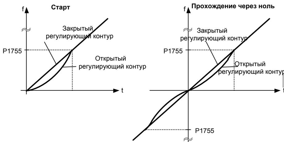
SLVC с открытым контуром означает, что наблюдатель не подает обратного сигнала для регулятора скорости (см. схему ниже).
