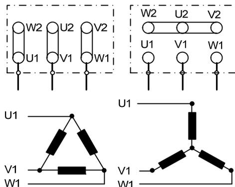
Соед.треугольником –Соединение звездой
