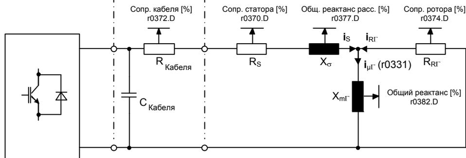
Пересчет: Т-схема замещения --> Invers - Γ - схема замещения
