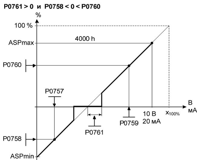
Пример ниже дает аналоговый вход от -10 до +10 В (-50 до +50 Гц) с нулевой точкой и "контрольной точкой" шириной 0,2 В (по 0,1 справа и слева от контрольной точки, ADC-значение -10 до +10 В, -50 до +50 Гц):
