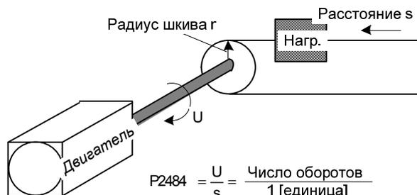
Равенство ниже определяет число оборотов для затормаживания двигателя:
