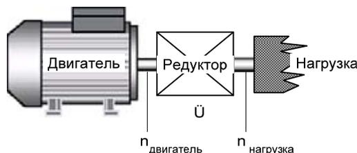
$$U = \frac{\text{Обороты двигателя}}{\text{Обороты нагрузки}} = \frac{P2481}{P2482}$$
