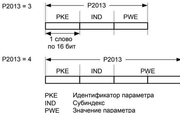
Если была выбрана постоянная длина слов, то может быть передано только одно значение. Это необходимо учитывать и для индексированных параметров, в отличие от переменной длины PKW, когда и весь индексированный параметр может быть передан за одно задание. При постоянной длине PKW она должна быть выбрана так, чтобы значение могло быть включено в телеграмму.
