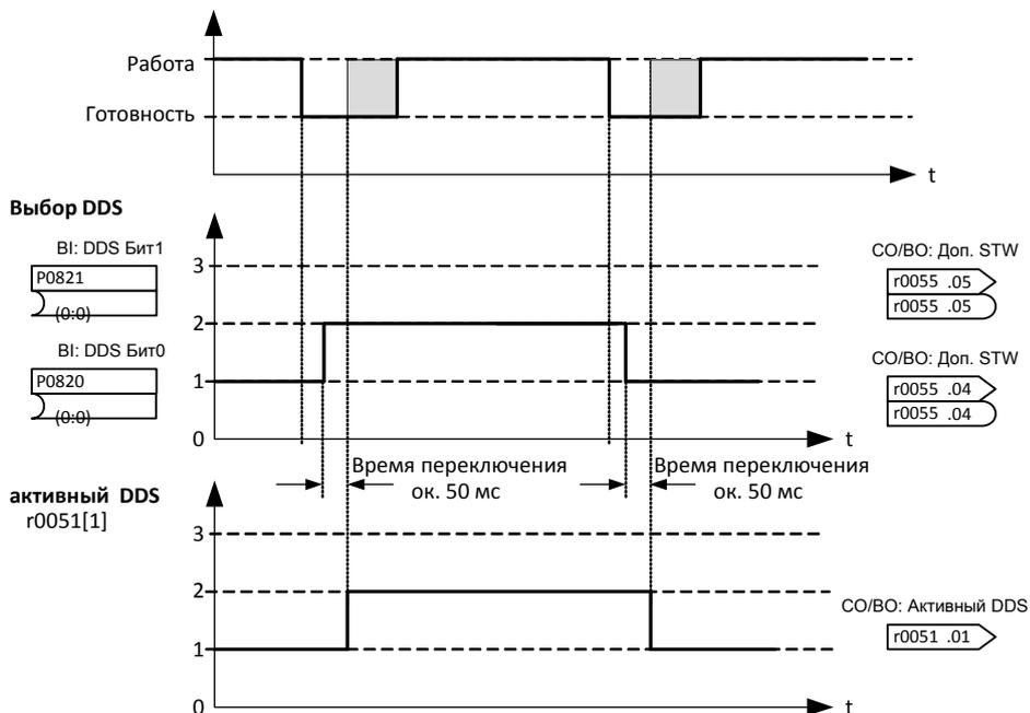
Текущий активный блок данных привода (DDS) отображается через параметр r0051[1] :
