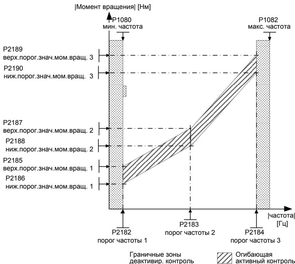
Допустимый рабочий диапазон представлен заштрихованной областью. Если момент нагрузки находится вне этой области, то следует определенная в P2181 реакция (предупреждение или ошибка).
