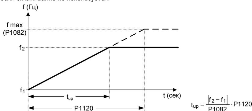
Установка слишком короткой ramпы разгона может привести к отключению преобразователя (ток перегрузки).
