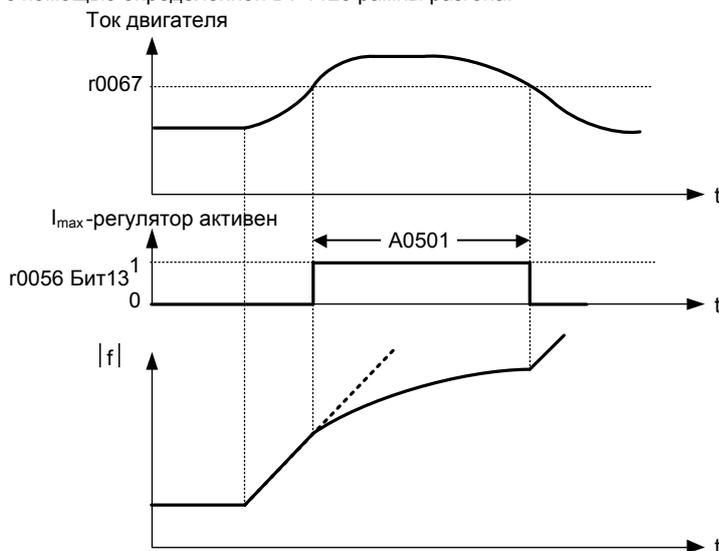
При линейном управлении  $U/f$  в текстильной промышленности, управлении по потокоцеплению в текстильной промышленности или внешнем управлении  $U/f$  для снижения тока используется только регулятор напряжения  $I_{max}$  (см. параметры P1345 и P1346).
