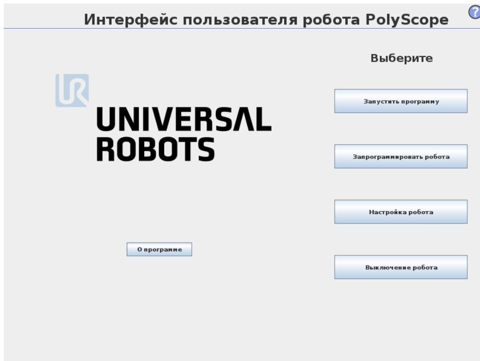
На рисунке выше показан экран приветствия. Синим цветом на экране выделены кнопки, которые можно нажать на экране пальцем или обратной стороной ручки. В интерфейсе PolyScore создана иерархическая структура экранов. В среде программирования экраны сгруппированы по вкладкам для удобства доступа к экранам.
