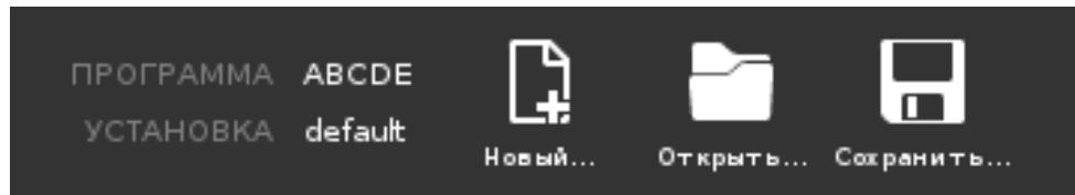
Менеджер программ и установок — это три значка, позволяющие создавать, загружать и конфигурировать программы и установки: Создать..., Открыть... и Сохранить.... В пути файла отображается имя текущей загруженной программы и тип установки. Путь файла изменяется при создании или загрузке новой программы или установки. Для робота может быть доступно несколько установочных файлов. Созданные программы загружают и используют активную установку автоматически.
