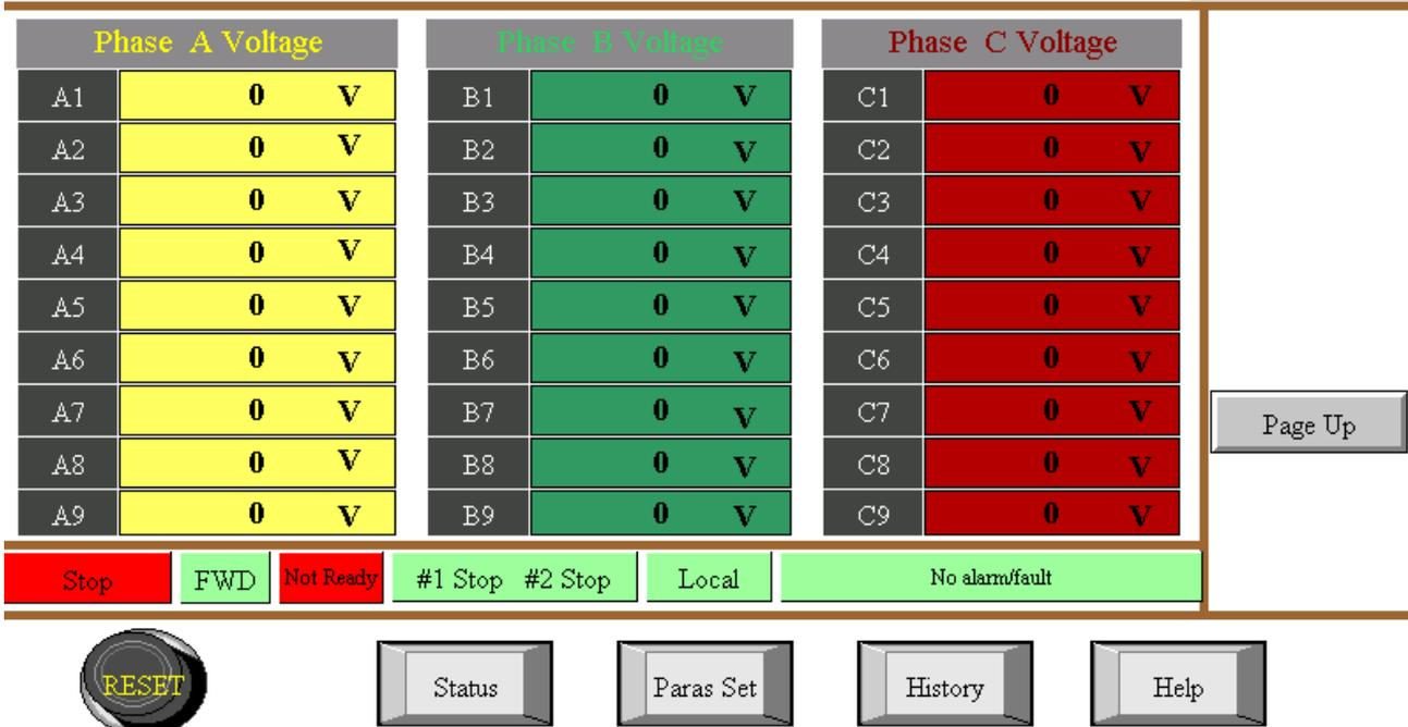
Рисунок 4.6 Пятая страница отображения состояния сенсорного ЖК-экрана высоковольтной системы ВСПЧ АСН100
