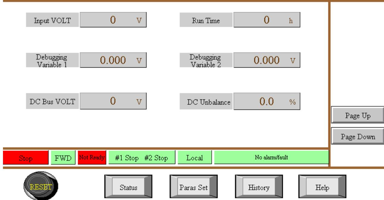
Рисунок 4.3 Вторая страница отображения статуса сенсорного ЖК-экрана высоковольтной системы ВСРЧ АЧ100
